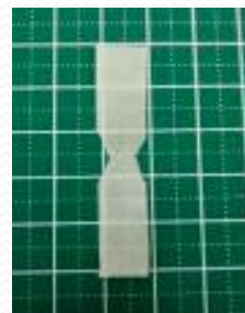
無塵紙にwet30 μm塗布・硬化
